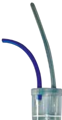
Insektsugeren virker som en støvsuger. Fx til indsamling af smådyr under bark eller i træerødder.
